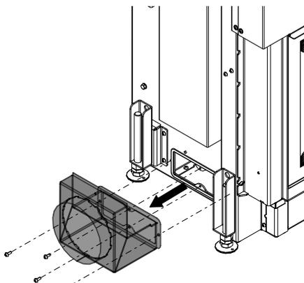
Abb. 32: Verbrennungsluftstutzen demontieren
