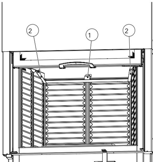
2) Keramott-Sicherung (1) entfernen.
