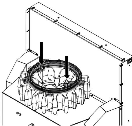
Abb. 43: Oberen Ring befestigen
