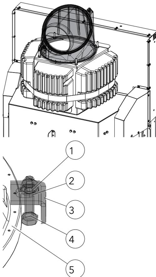
Abb. 37: Abgassammler montieren
