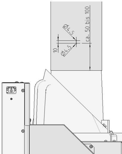
Abb. 66: Bohrschema-Rauchrohr
