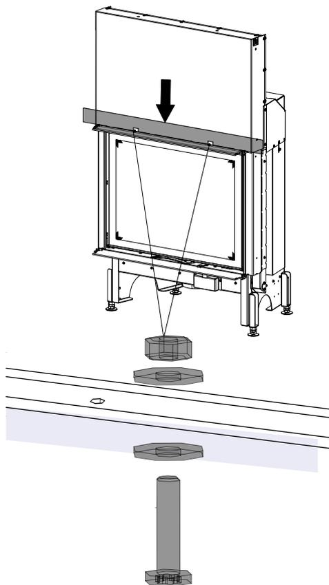
Abb. 54: Designrahmen oben montieren
