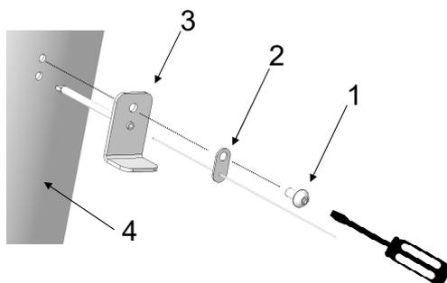
Abb. 67: Temperatur-Sensor montieren
