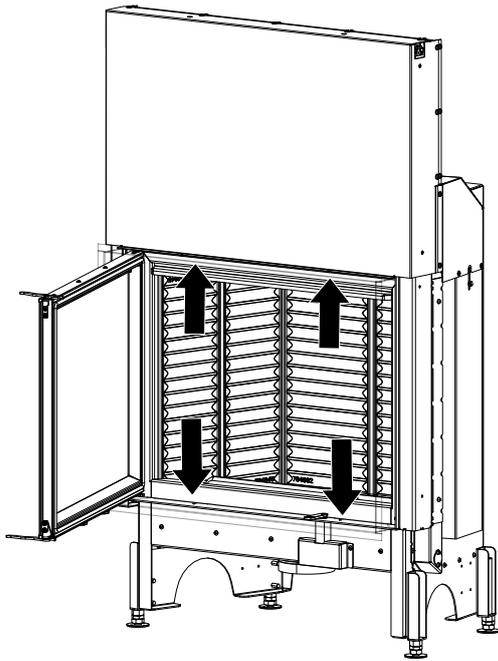
Abb. 53: Designrahmen befestigen
