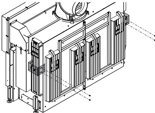
Abb. 50: Halterung befestigen
