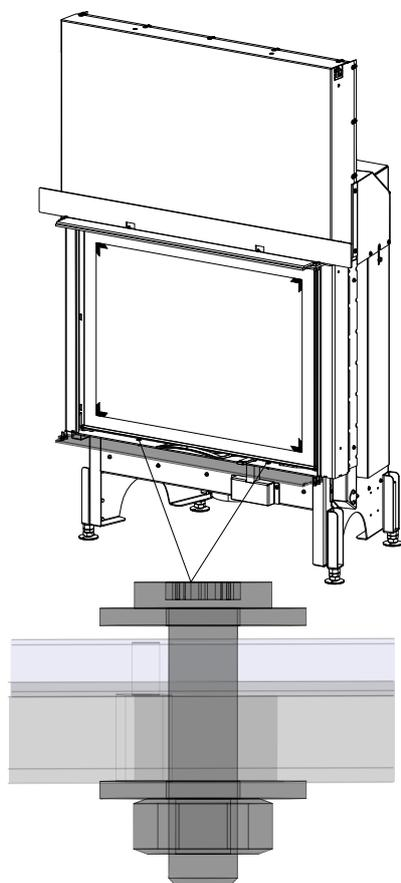
Abb. 55: DRM unten montieren
