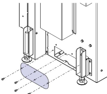
Abb. 33: Abdichtplatte demontieren
