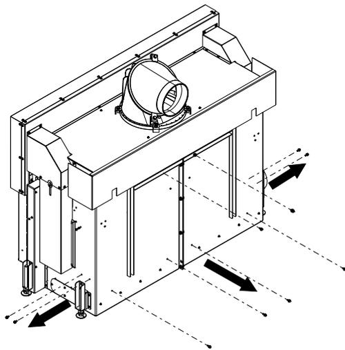
Abb. 46: Schrauben lösen
