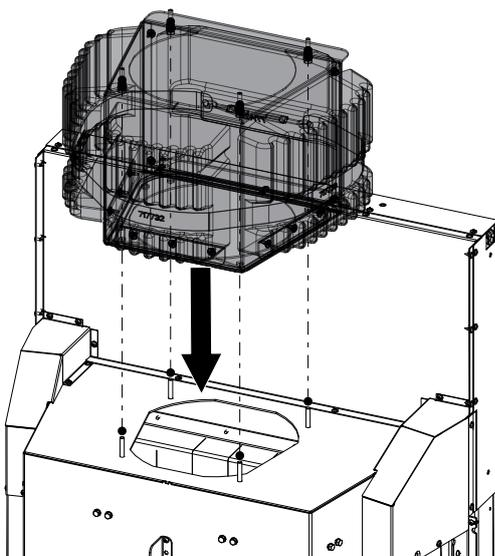
Abb. 36: Aufsatzspeicherbox groß auf die Bolzen anbringen
