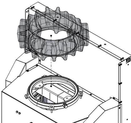
Abb. 41: Aufsatzspeicherstein aufsetzen
