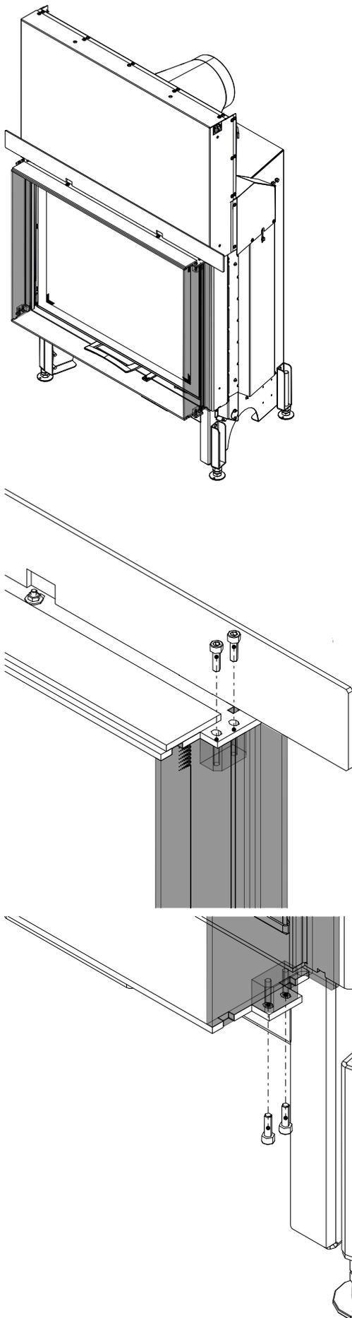
Fig. 56: Fixer les côtés du cadre design massif
