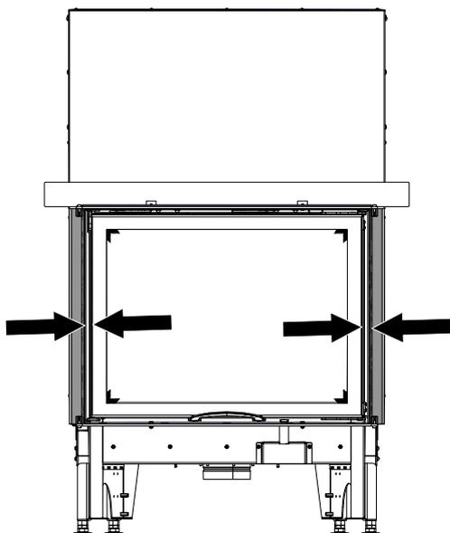
Fig. 57: Ajuster uniformément le cadre design
