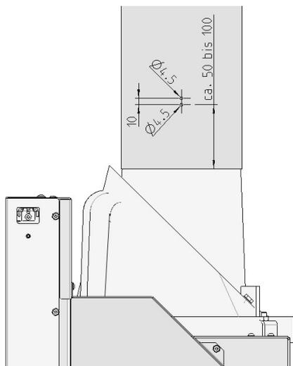
Fig. 66: Schéma de perçage pour conduit de fumée
