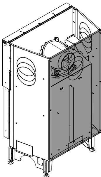
Fig. 61: Installer la paroi arrière
