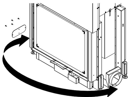
Fig. 34: Invertir les pièces
