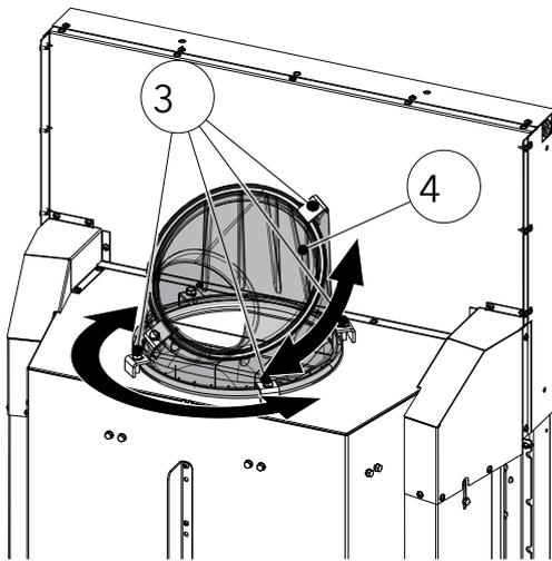
Fig. 84: Régler la buse de l'avaloir de fumées
