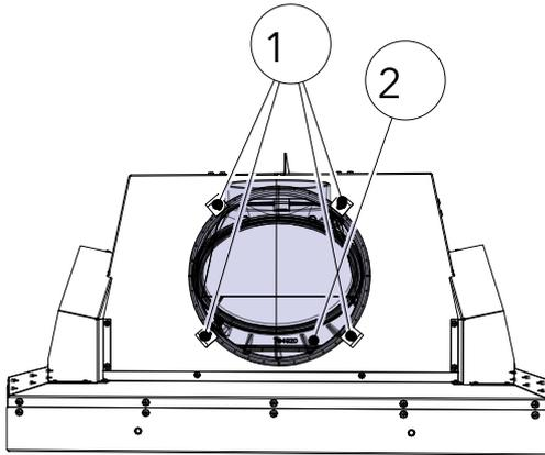
Fig. 83: Orienter l'avaloir de fumées dans la position souhaitée (vue de dessus)
