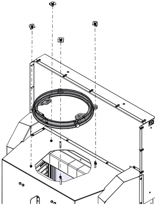
Fig. 39: Installer l'anneau de fixation inférieur
