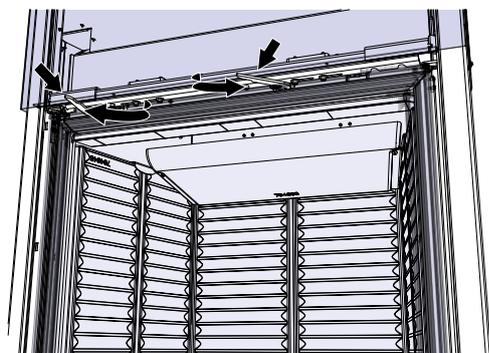
Fig. 88: Bloquer la remontée de la porte
