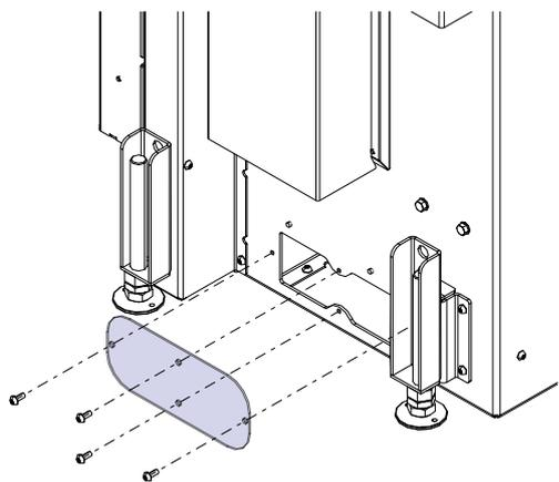
Fig. 33: Déposer la plaque d'étanchéité
