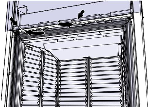
Fig. 78: Bloquer la remontée de la porte
