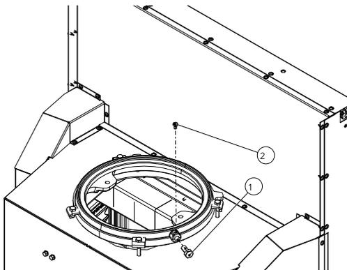
Fig. 40: Fixer la vis ou la sonde
