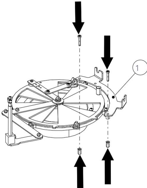
Fig. 70: Installer le kit de montage
