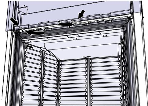
Fig. 26: Bloquer la remontée de la porte
