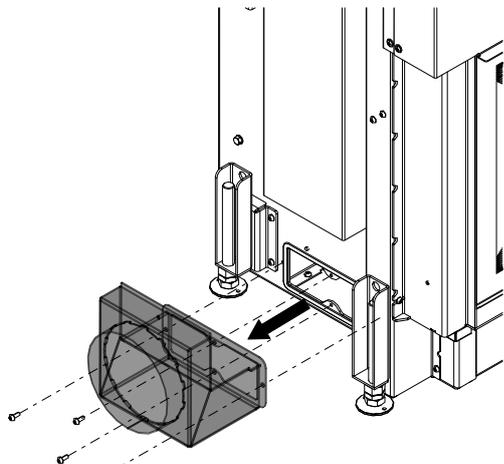
Fig. 32: Déposer la buse d'entrée d'air de combustion
