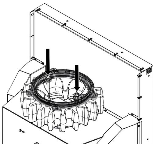
Fig. 43: Fixer l'anneau de fixation supérieur
