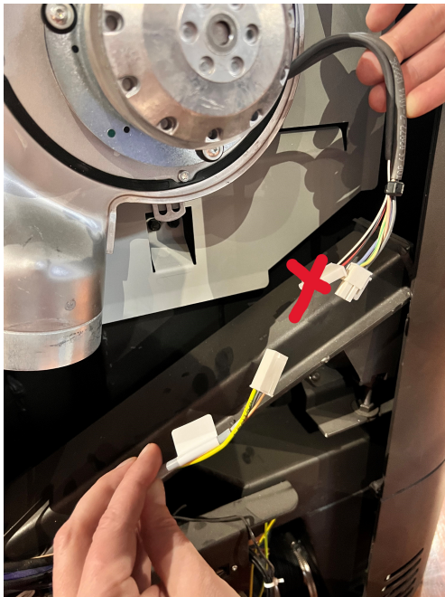
Fig. 9: Collegamento del cavo
