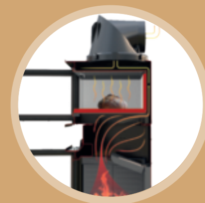
⇒ VANO FORNO / VISTA IN SEZIONE
