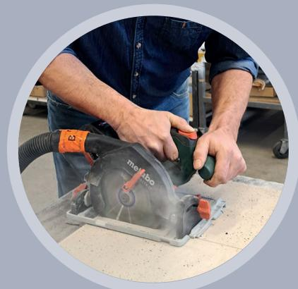
⇒ SCHNEIDEN MIT HANDKREISSÄGE
