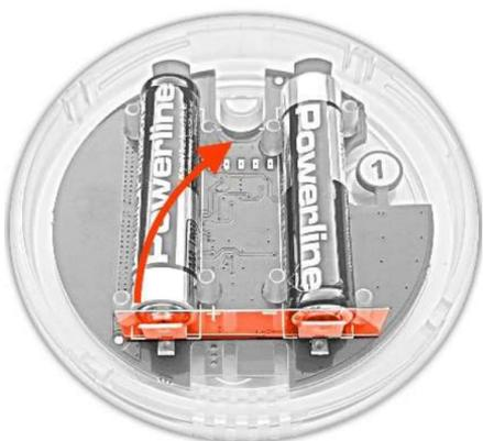
Retirez la languette d'isolation du contact des piles.
