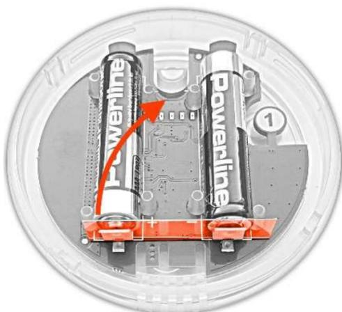
Rimuovere la linguetta isolante dai contatti delle batterie.
