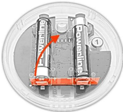
Entfernen Sie den Isolierstreifen von den Batteriekontakten.
