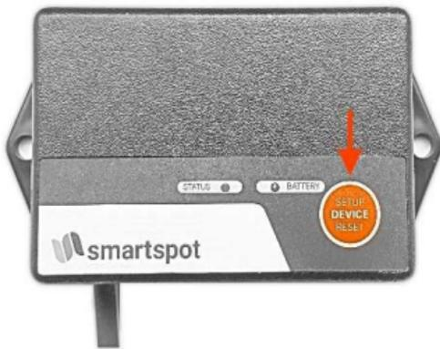
Danach drücken Sie die „Setup“ Taste am Receiver. Die LED beginnt schnell grün zu blinken.
