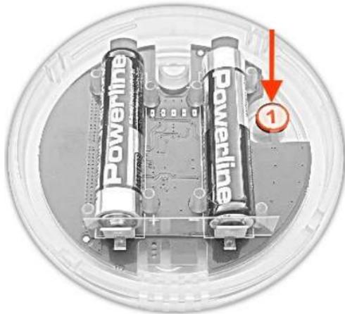
Nun drücken Sie kurz die mit „1“ markierte Taste des SmartSpot Sensors. LED blinkt nun grün.
