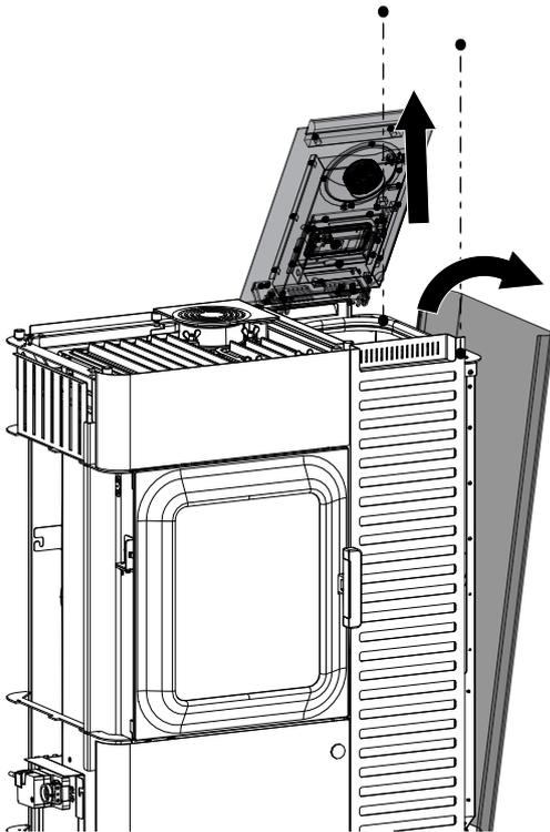
Fig. 3: Smontaggio del rivestimento laterale destro
