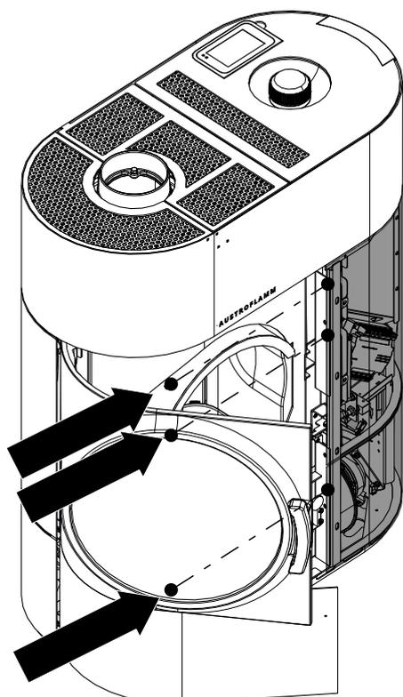
Fig. 17: Svitamento delle viti
