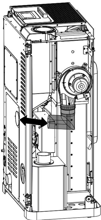
Fig. 52: Collegamento con tubo di collegamento
