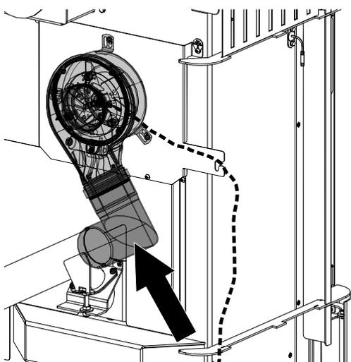
17) Inserire il pezzo di tubo a L in dotazione nel modulo del diffusore dell'aria.
