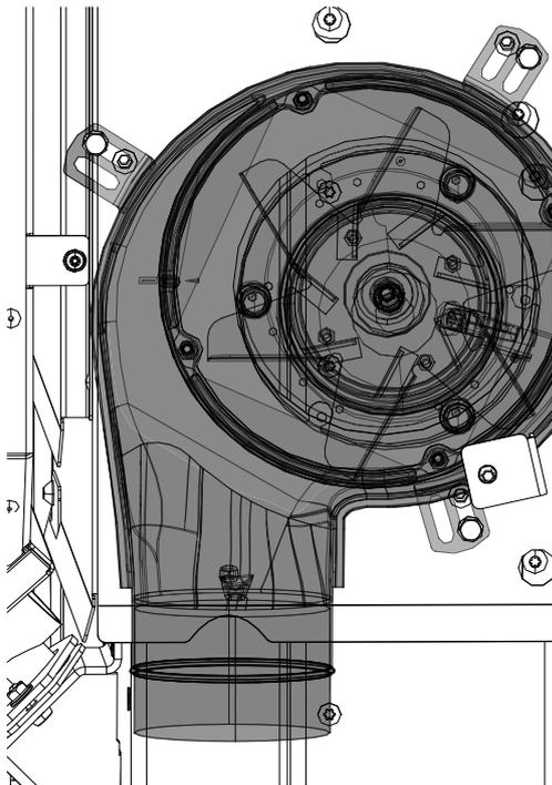
Fig. 46: Montaggio del modulo di distribuzione dell'aria
