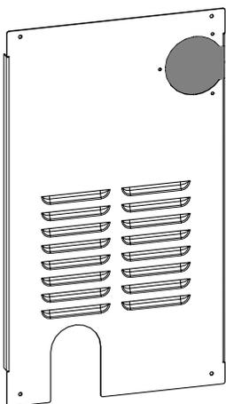
Fig. 53: Rimozione della parte perforata
