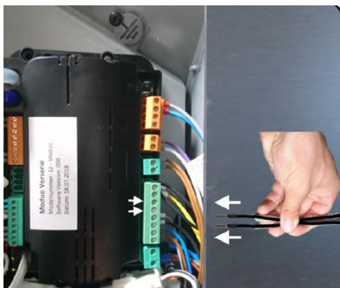
Fig. 25: Collegamento del modulo del diffusore dell'aria
