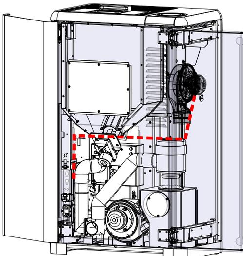
Fig. 48: Passaggio del cavo
