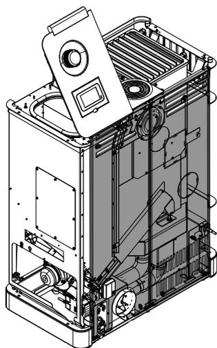
Fig. 5: Rimozione della parete posteriore
