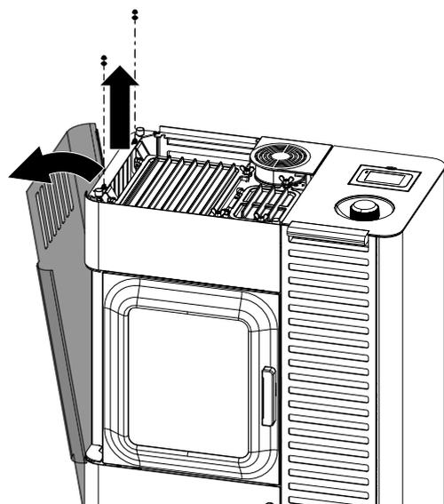
Fig. 2: Smontaggio del rivestimento laterale sinistro
