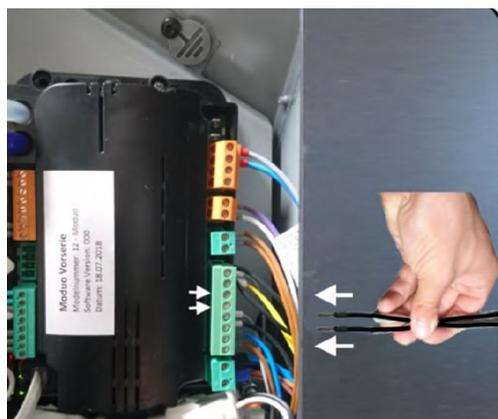
Fig. 37: Collegamento del modulo del diffusore dell'aria
