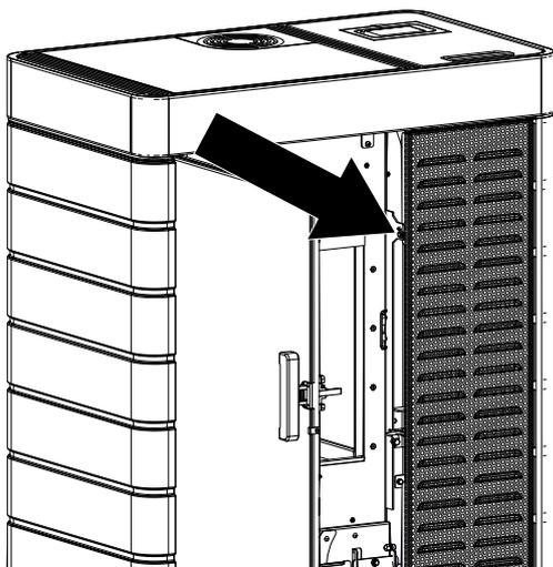
Fig. 31: Smontaggio del rivestimento laterale anteriore
