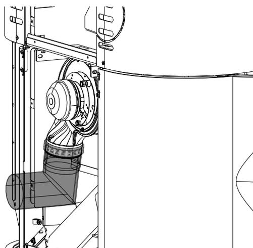
16) Inserire il pezzo di tubo a L in dotazione nel modulo del diffusore dell'aria.
