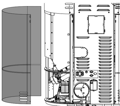
Fig. 19: Rimozione del rivestimento laterale
