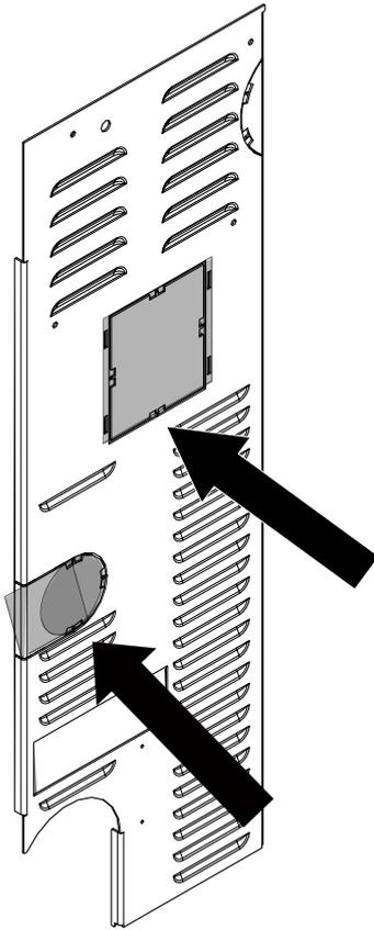
Fig. 28: Rimozione della parte perforata
