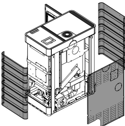
Fig. 32: Rimozione della parte posteriore e dei rivestimenti laterali
