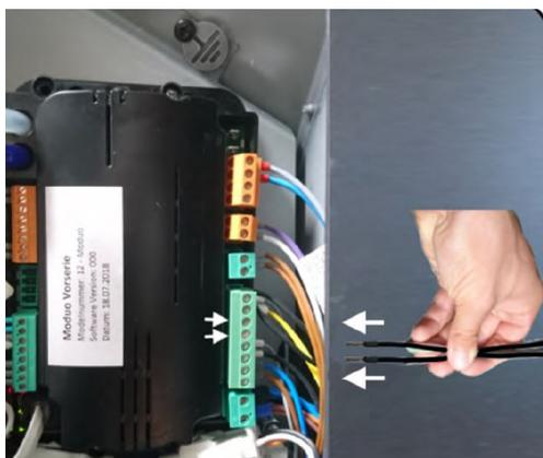
Fig. 50: Collegamento del modulo del diffusore dell'aria
