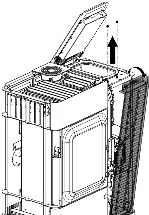
Fig. 4: Smontaggio del rivestimento laterale anteriore
