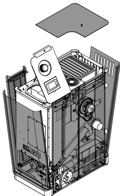
Fig. 41: Rimontaggio di tutte le parti
