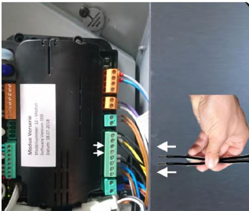
Fig. 10: Collegamento del modulo del diffusore dell'aria
