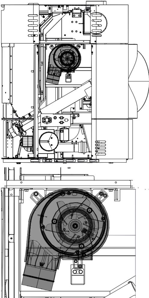
Fig. 21: Montaggio del modulo dell'aria
