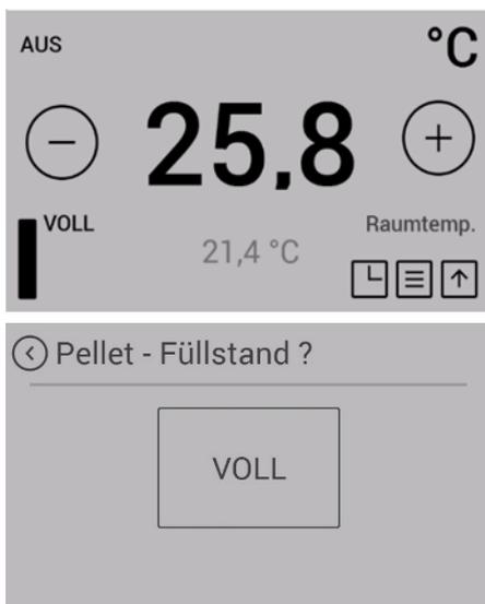
Die Füllstandsanzeige informiert Sie über den Füllstand Ihres Pelletbehälters. Wenn der Füllstand unter ein bestimmtes Level fällt, wird eine Warnung am Display angezeigt. Die Füllstandsanzeige muss bei jeder Befüllung manuell aktualisiert werden.
