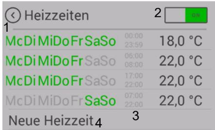
Durch Drücken der Taste „TIMERS“ in der Heizleistungsanzeige gelangen Sie in das Menü „Heizzeiten“.
