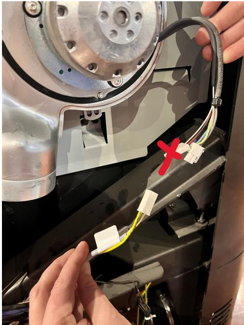
Abb. 75: Kabel verbinden
