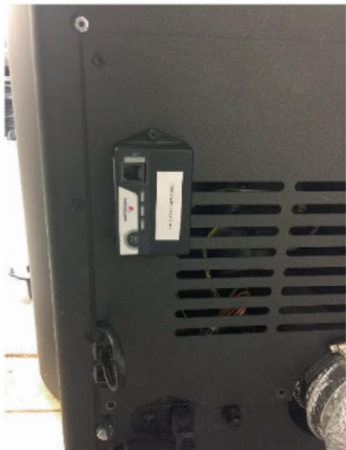
2) Montieren Sie die WiRCU-Box nun in der abgebildeten Lage auf die Rückwand.
