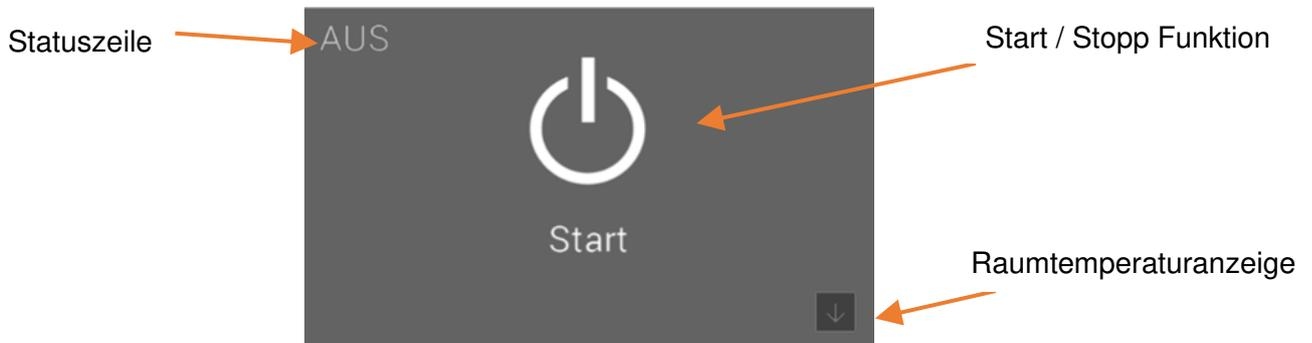
Durch Drücken der **Start / Stopp** Taste für länger als 2 Sekunden wird der Ofen gestartet bzw. gestoppt
