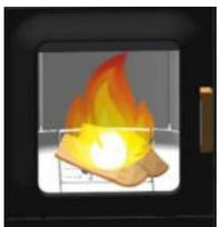
In diesem Betriebsstatus wird nach ca. 2 Minuten der Kipprost geöffnet und damit die Primärluftklappe geschlossen und das Scheitholz weiter angefacht, bis eine bestimmte Feuerraumtemperatur (abhängig von der eingestellten Heizleistung) erreicht wird. Ist diese erreicht, wechselt der Ofen in den Status „Scheitholzbetrieb“
