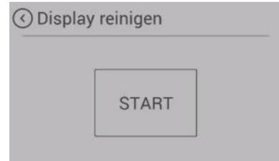
Um sicherzustellen, dass beim Reinigen des Displays keine Funktion ungewollt gestartet wird, drücken Sie auf „Start“. Das Display wird für 30 Sekunden gesperrt.
