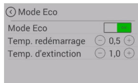
Pour éviter que le poêle ne s'arrête et redémarre trop souvent, laissez une certaine marge entre ces seuils. Le poêle doit fonctionner pendant au moins une heure pour arriver à sa température de service.
