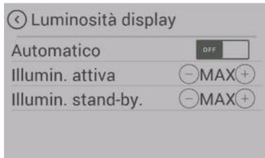
Definisce la luminosità del display durante il funzionamento e durante la modalità di riposo.
