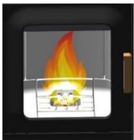
Nella modalità pellet la quantità di pellet e l'aria comburente affluiscono conformemente alla potenza termica impostata.
