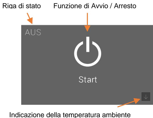
Premendo il tasto **Avvio / Arresto** per oltre 2 secondi si avvia o si arresta la stufa
