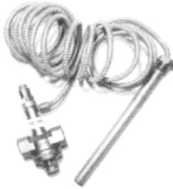
Die thermische Ablaufsicherung wird in die Kaltwasserleitung eingebaut. Im Kaltwasserzuluß, in der thermischen Ablaufsicherung und im Auslauf dürfen keine Absperrventile, Durchflussmengenbegrenzer oder ähnliches eingebaut werden. Der Auslauf muss zu einem offenen, einsehbaren Abfluss führen. Die Durchflussleistung muss min. 1000 l/h betragen (voll geöffnet).
