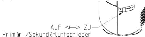
*Fig. 4: régler l'arrivée d'air*
