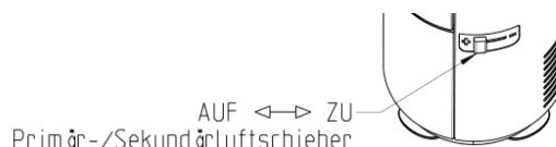
Fig. 4: Regolazione della levetta dell'aria
