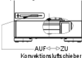
Konvektionsluftschieber = manette de régulation de l'air de convection
