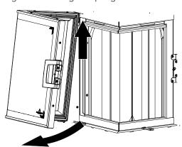
Fig. 56: Unhinging the firebox door
