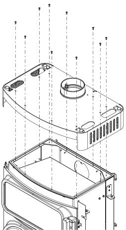
Fig. 33: Removing the lid
