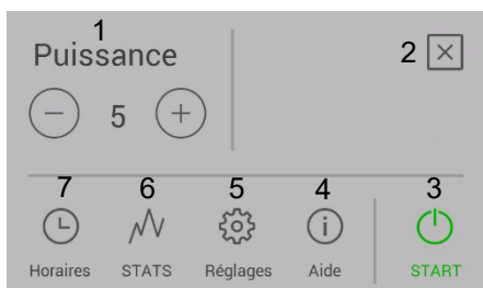
Fig. 28: Affichage de la puissance de chauffage
